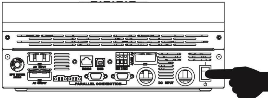
После установки устройства и подключения аккумулятора, нажмите выключатель питания On/Off, чтобы включить устройство. Кнопка включения находится на нижней части инвертора.
