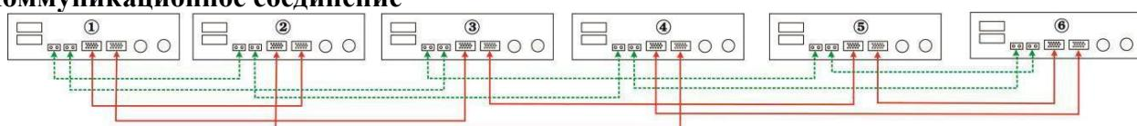
Семь инверторов подключены параллельно:
