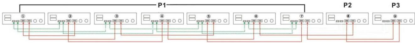
**ПРЕДУПРЕЖДЕНИЕ:** Не подключайте кабель распределения тока между инверторами, которые находятся в разных фазах. В противном случае, это может привести к выходу инверторов из строя.
