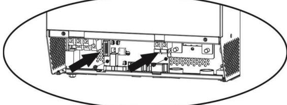
**Шаг 6:** Переподключите 2-контактные и 14-контактные кабели.
