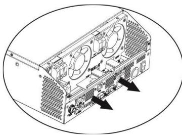
**Шаг 3:** Открутите 2 винта (см. ниже) и отсоедините 2-контактные и 14-контактные кабели. Извлеките плату из-под коммуникационных плат.
