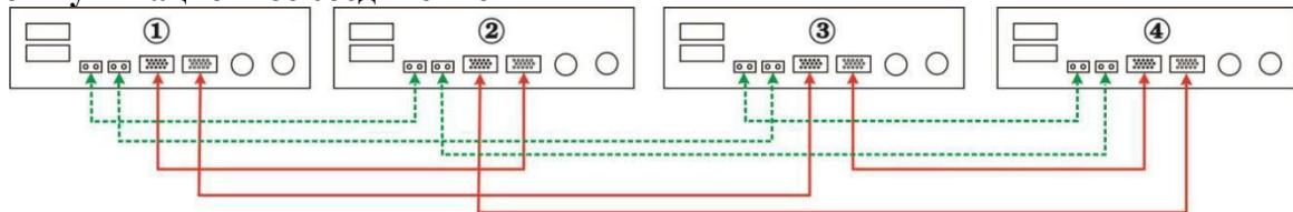
Пять инверторов подключены параллельно:
