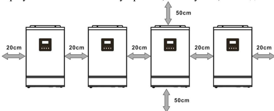
**ПРИМЕЧАНИЕ:** Для правильной циркуляции воздуха и рассеивания тепла, выдерживайте расстояния до ближайших устройств согласно приведенной выше схеме. Устанавливайте блоки на одном уровне.
