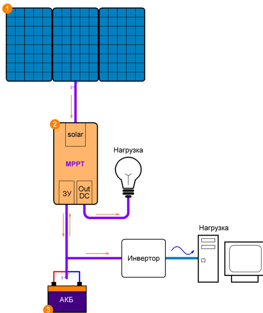
В систему необходимо добавить инвертор, преобразующий постоянный ток от аккумуляторов в переменный 220В.
